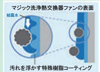
マジック洗浄熱交換器フィンの表面は、水がなじみやすいコーティングを採用。結露水が汚れと物質との間に入り込むことで、汚れを浮かせて洗い流します。
